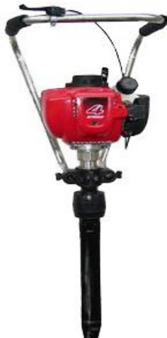
ZCD-300 型直动捣固镐系我公司研发的一种便携式铁路专用养路机具。该机采用高频激振原理对道床石碴进行密实捣固。适用于日常线路保养、封闭作业、抗洪抢险及岔群地段捣固作业。
